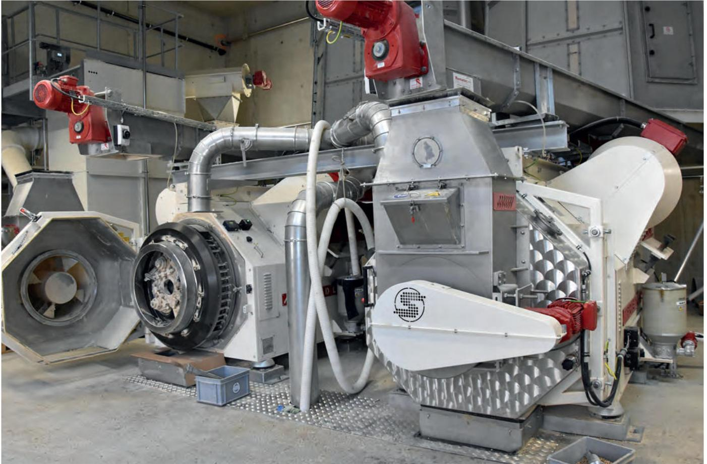
■ Die Pelletieranlage produziert nachhaltige Holzpellets aus Sägemehl und Restwärme.
